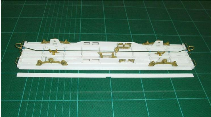
Weiter werden die Bremsklötzen mit den Brems-Dreiecken verbunden und in ihre Führungen gesetzt.
