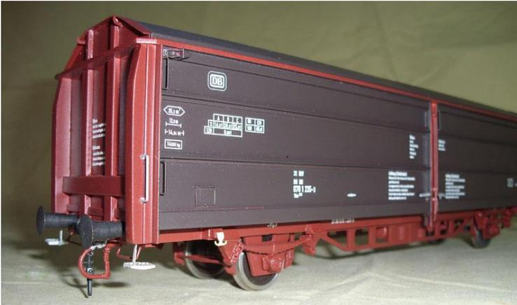
Nach Einbau von den Rädern mit Gleitlager ist der Schiebe- Wand und -Dach Wagen Gattung Tbis 875 fertig für den Dienst.
