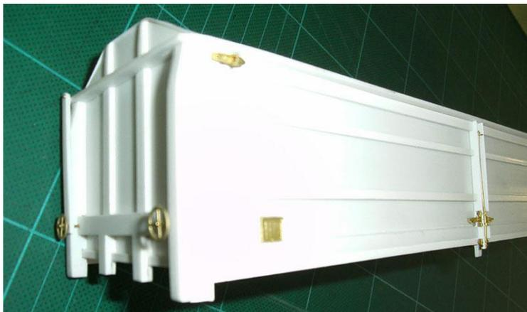
Aus den Winkelprofilen in die Seitenmitte werden kleine Aussparungen geschnitten für die Quergriffe von der Türverriegelung.
