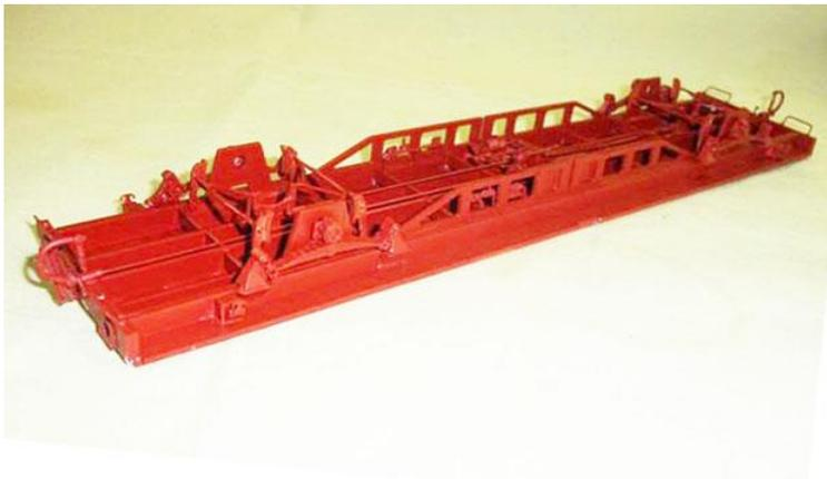
Nachdem die Schaltergestänge eingebaut sind, wird das Unterrahmen rotbraun (Ral 8012) angestrichen.
