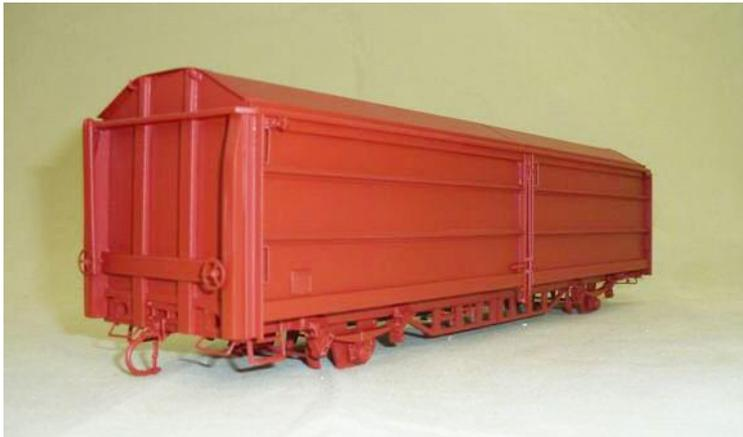
Nach Grundierung wird das Gehäuse rotbraun (Ral 8012) angestrichen weil die Tür- und Dach-Platten einem Anstrich bekommen in grau braun. (Ral 8019)
