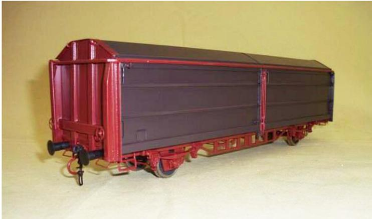
Seilhaken, Handräder und Griffe werden gelb (Ral 1023) angestrichen. Rangiertritten und die Bremsschlauchzapfen werden in Alu eingefärbt, weil die Bremsschlauche mattschwarz sind.
